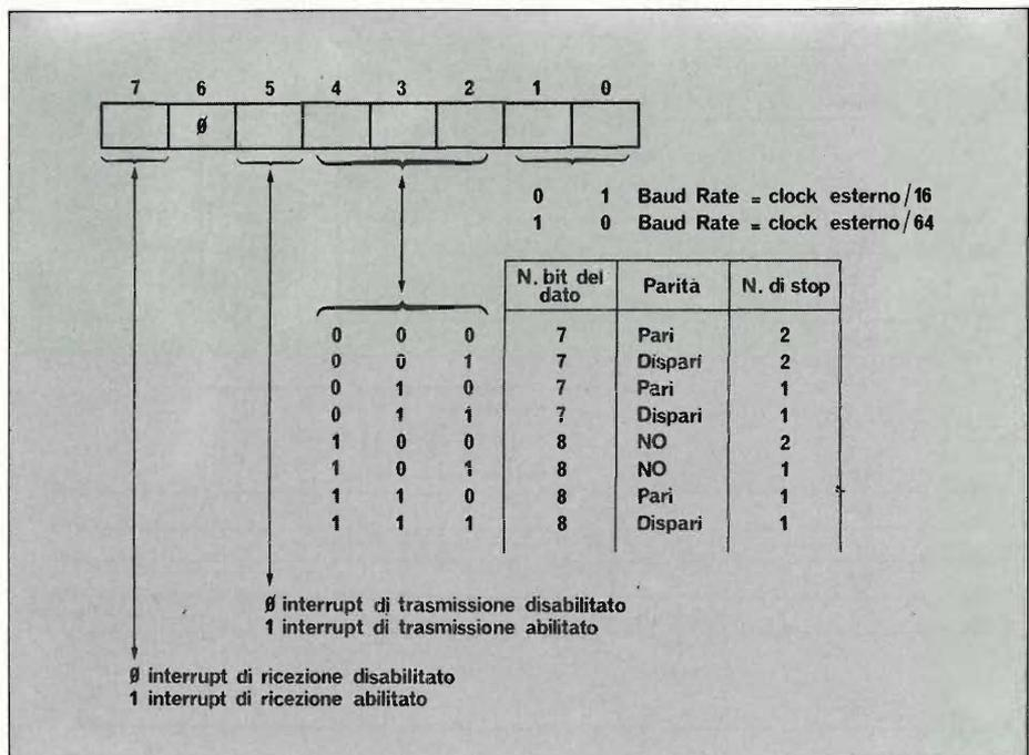
Fig. 7 - Significato dei bit del Control Register.
