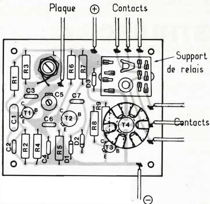
Fig. 13 - Disposizione dei componenti sulla basetta dell'allarme a prossimità.
