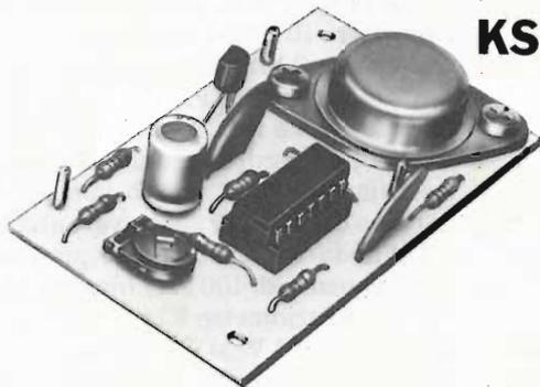
Sistema di ritardo che evita lo spegnimento immediato delle luci di cortesia dell'automobile alla chiusura delle porte. Il tempo è regolabile e permette, per esempio, di inserire la chiave di accensione, o di eseguire qualsiasi altra manovra, senza
