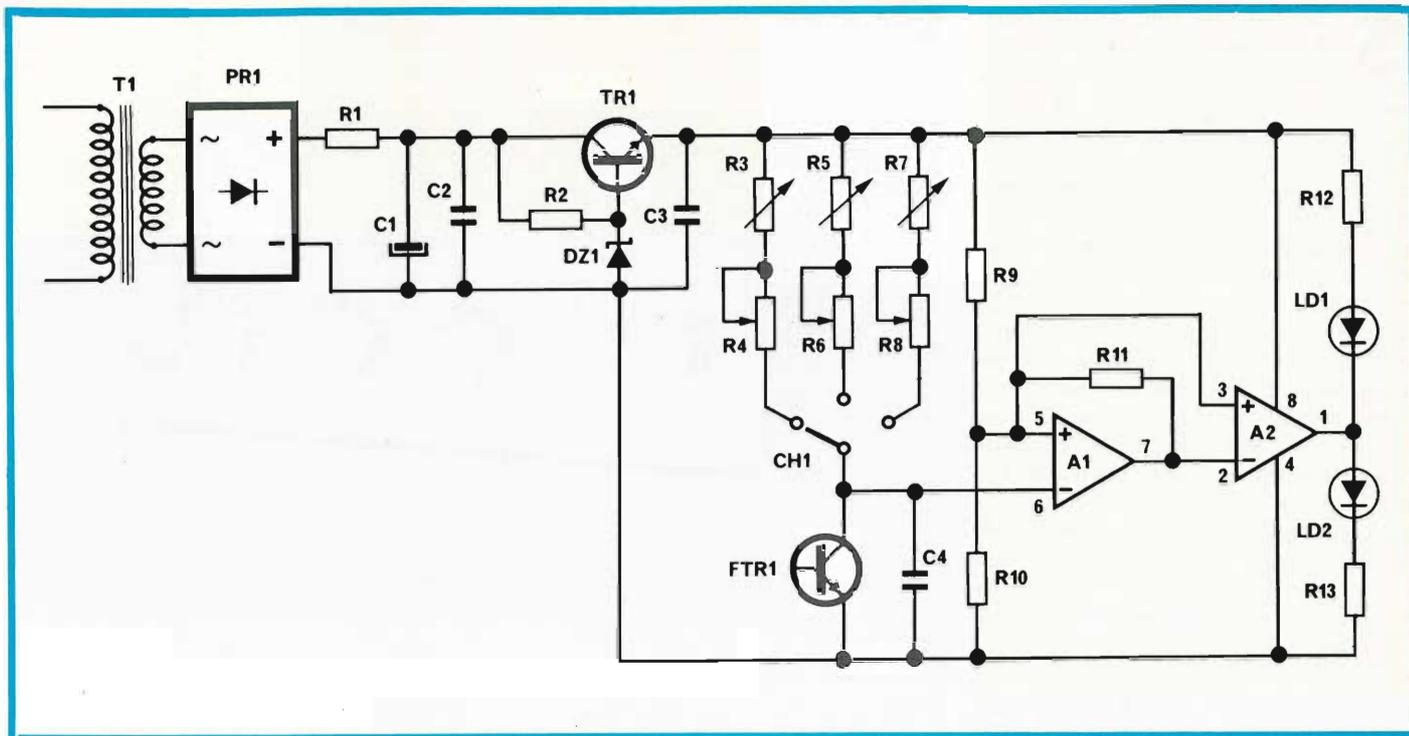
Fig. 1 - Schema elettrico dell'analizzatore per fotografie a colori.
