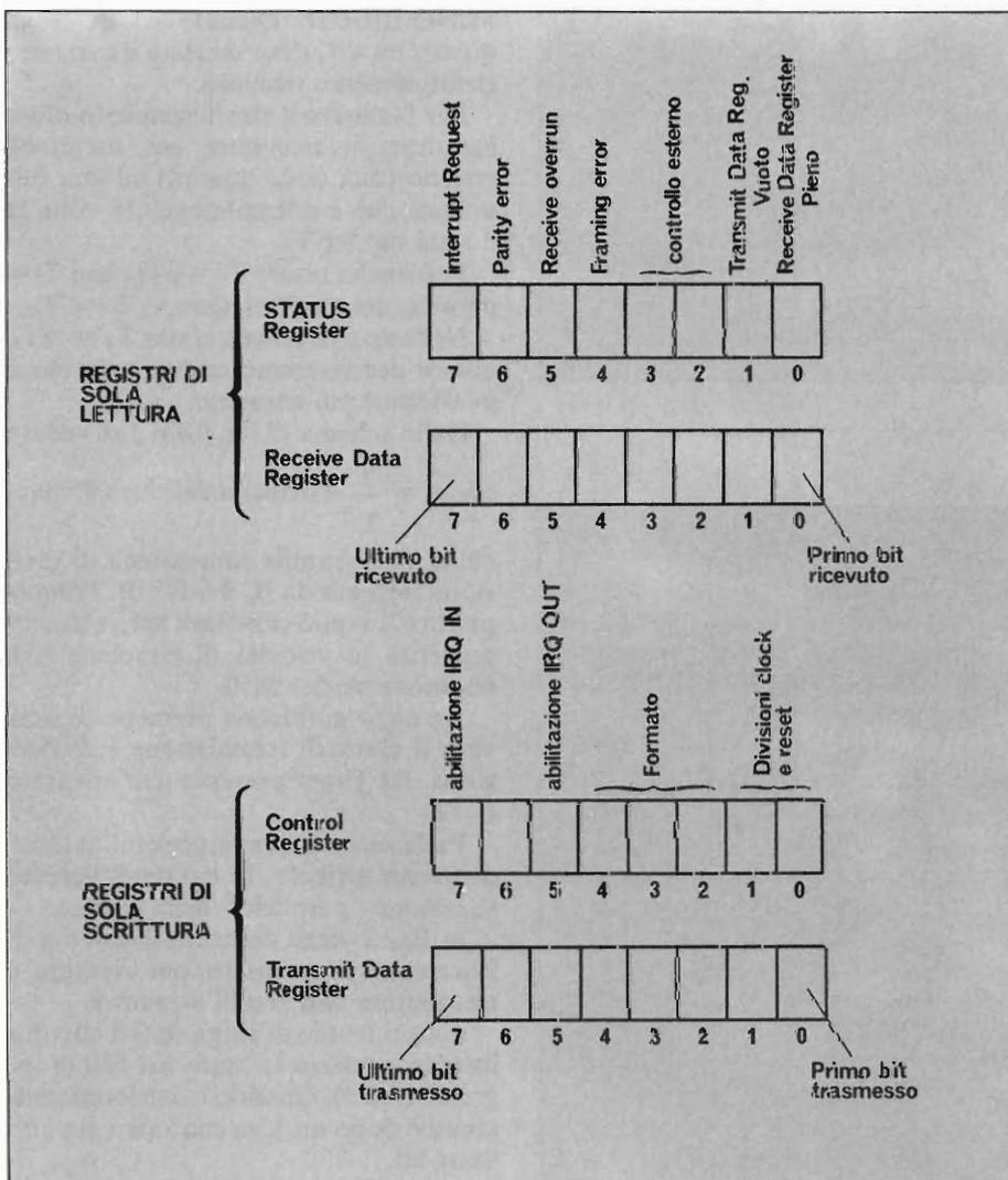
Fig. 6 - Configurazione dei registri di lettura e scrittura.
