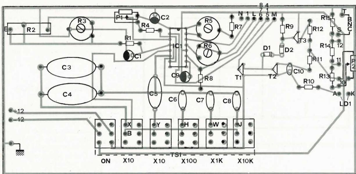
Fig. 2 - Disposizione pratica dei componenti del generatore.
