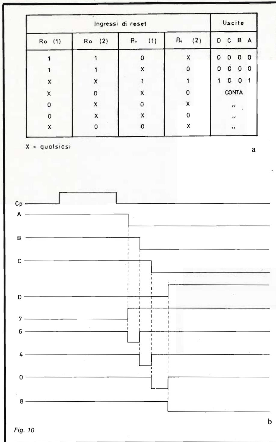
tore non stà conteggiando, ma stà rientrando nel ciclo principale. Mostriamo infine, come il contatore esaminato, può dar luogo alla non sincronizzazione delle uscite, con possibile formazione di impulsi spuri, (spiker), all'uscita di una eventuale decodifica.
