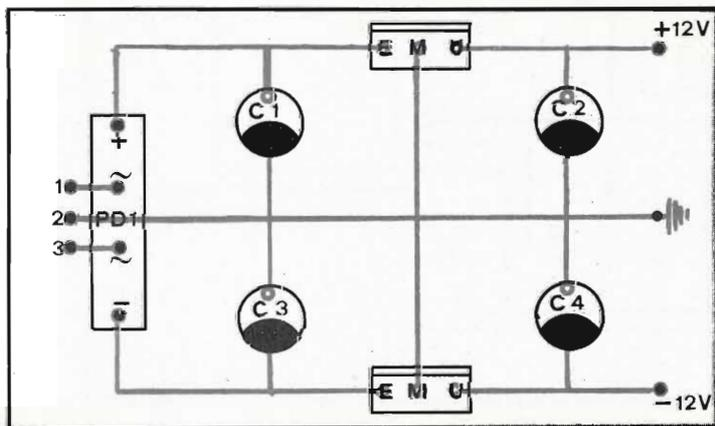
Fig. 5 - Piano pratico di montaggio dell'alimentatore.
