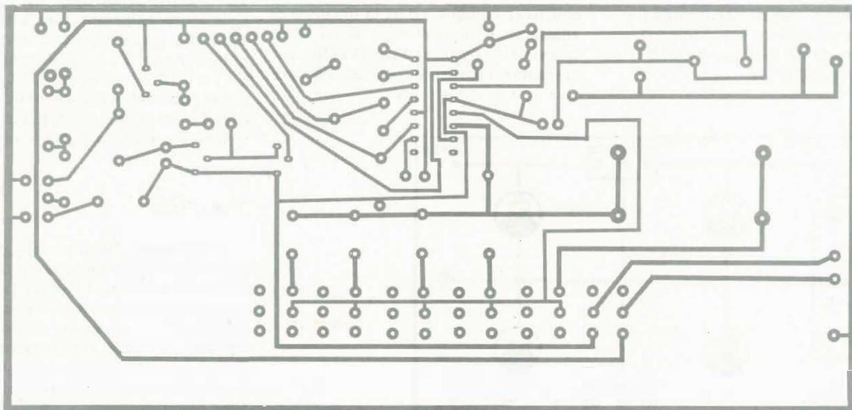
Fig. 3 - Circuito stampato del generatore visto dal lato rame in scala 1:1.
