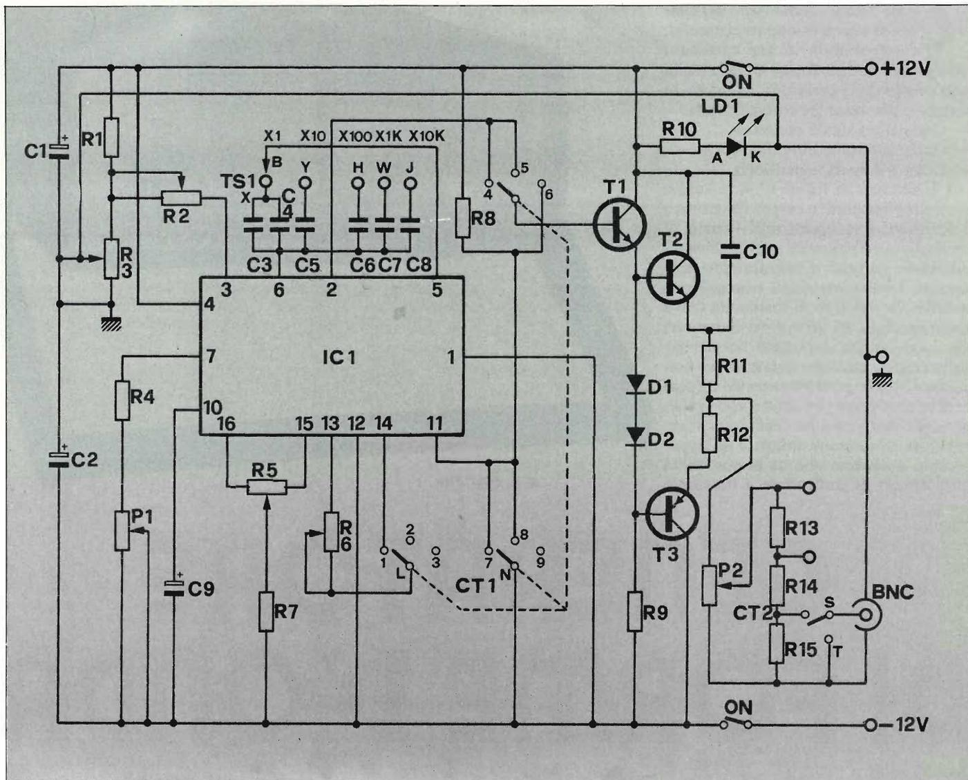
Fig. 1 - Circuito elettrico del generatore.
