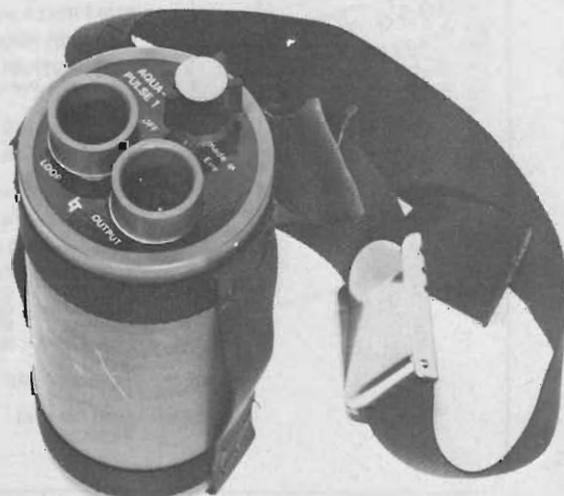
Aspetto esteriore del singolo rivelatore di metalli subacquei.
