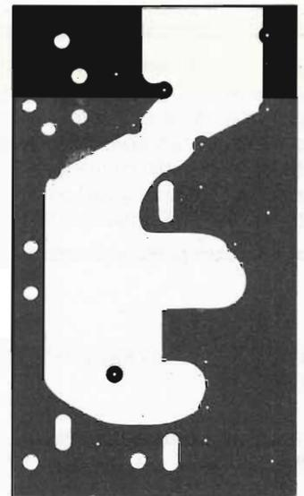
Fig. 4 - Bassetta ramata superiore in scala 1:1.
