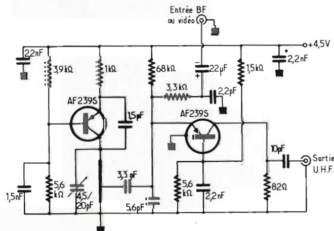
Fig. 3 - Schema elettrico del modulatore video descritto.
