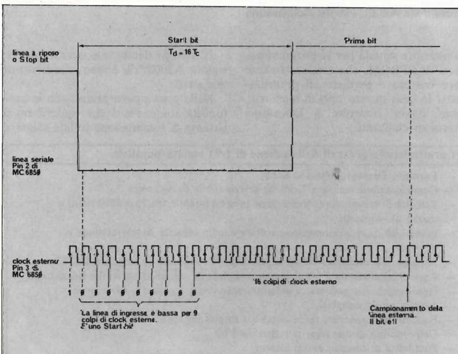
Fig. 2 - Sincronizzazione di un carattere in ricezione.
