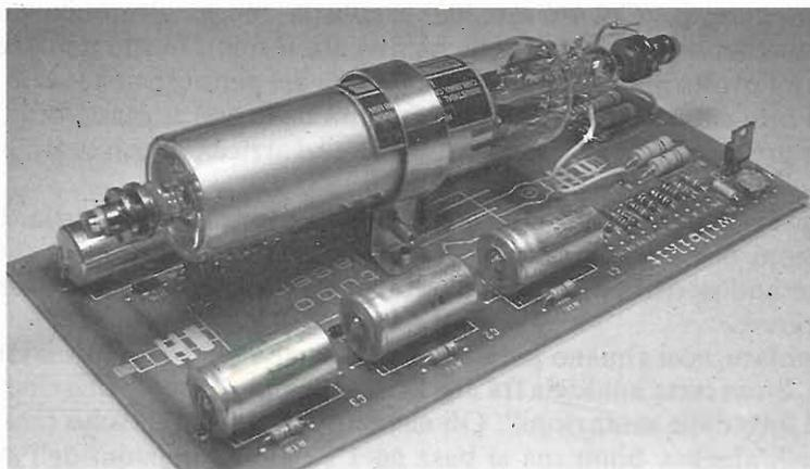
Costruisci un generatore laser da 5 mW di potenza. Una scatola di montaggio per preparare un laser a luce rossa adatta per esperimenti scientifici ed effetti psichedelici. La confezione comprende il circuito stampato inciso e serigrafato; i componenti necessari al montaggio ed il tubo laser da applicare direttamente sulla basetta. Il Kit è reperibile presso i distributori dei nostri prodotti oppure direttamente per corrispondenza.
