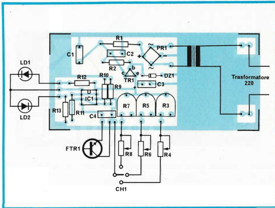
Fig. 3 - Disposizione dei componenti sulla basetta di figura 2.
