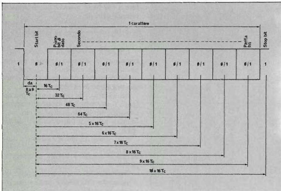
Fig. 4 - Configurazione e temporizzazioni di un carattere trasmesso.
