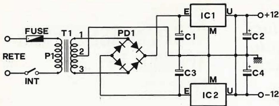
Fig. 6 - Circuito elettrico dell'alimentatore stabilizzato.
