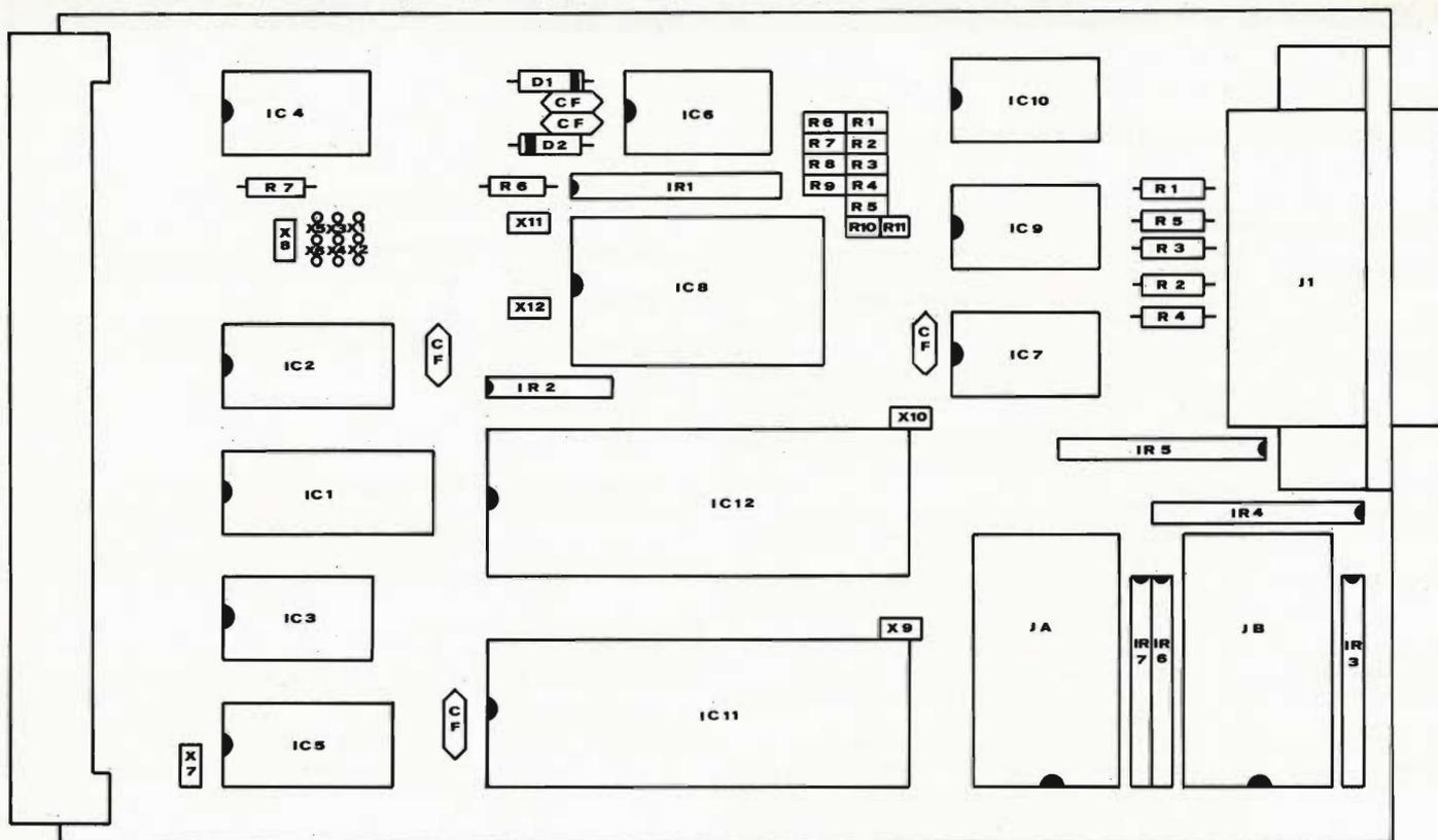
Fig. 10 - Serigrafia disposizione componenti sul circuito stampato scheda interfaccia I/O.
