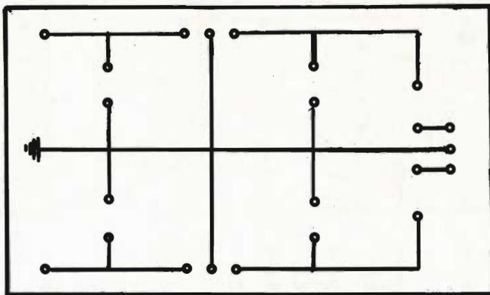
Fig. 4 - Basetta ramata a grandezza naturale dell'alimentatore.
