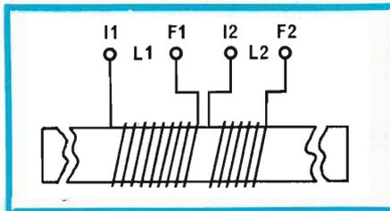
Fig. 4 - Realizzazione pratica della bobina su ferrite.
