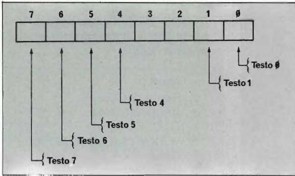
Fig. 8 - Significato dei bit dello Status Register.
