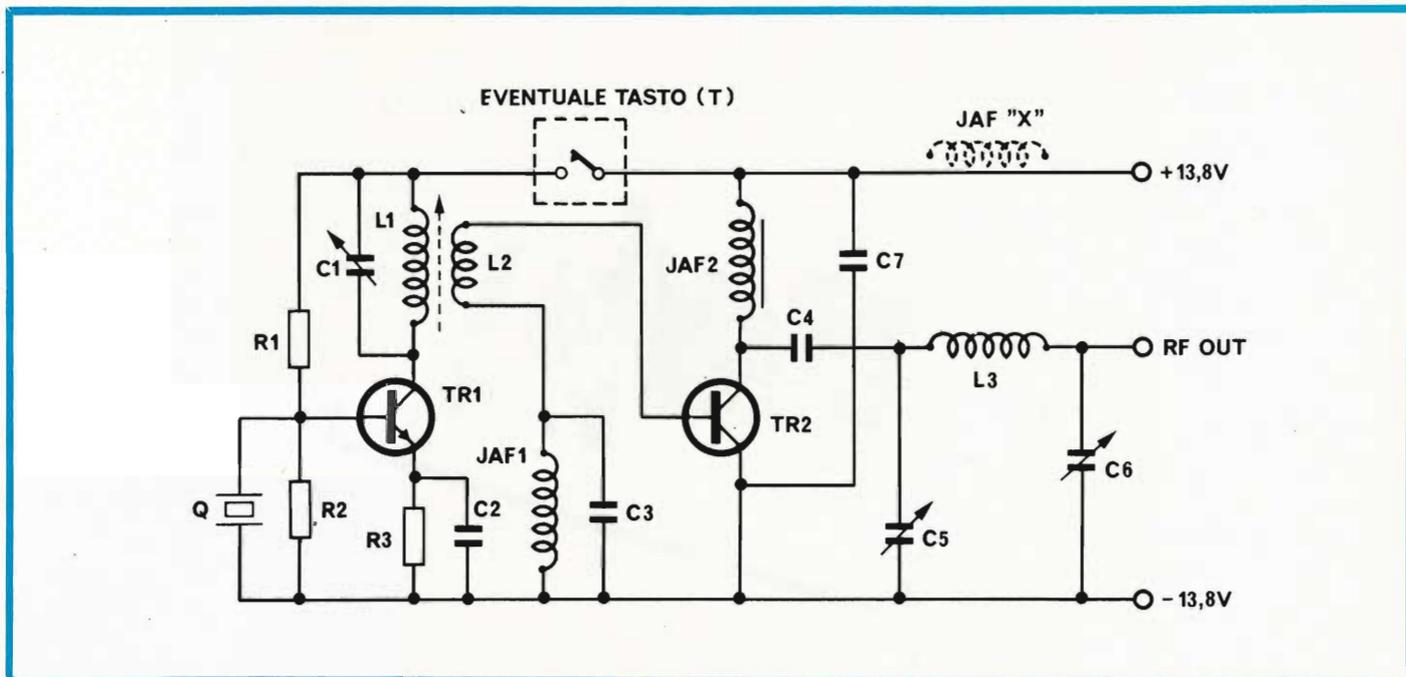
Fig. 1 - Schema elettrico "QRP" per onde corte e CB
