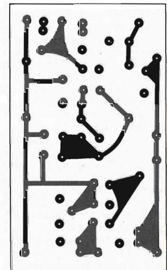
Fig. 5 - Bassetta ramata inferiore in scala 1:1.
