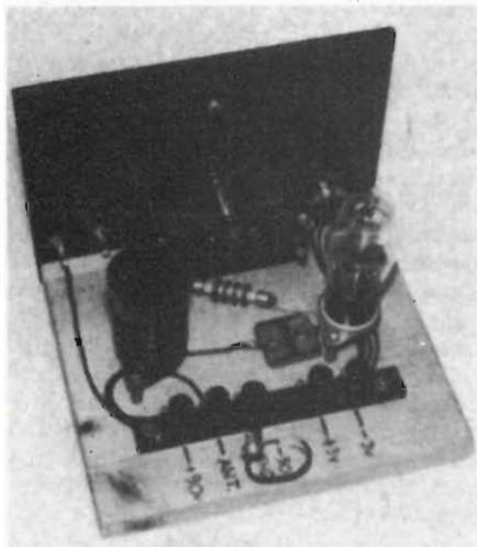
Fig. 9 - Vista interna del ricevitore monotubo a reazione per onde medio-corte.
