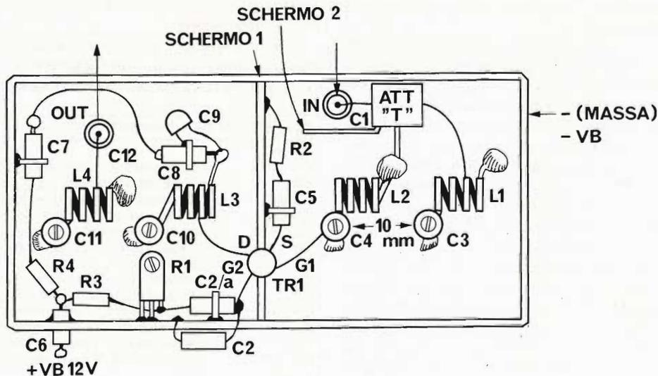
Fig. 2 - Disposizione dei vari componenti nel contenitore metallico.
