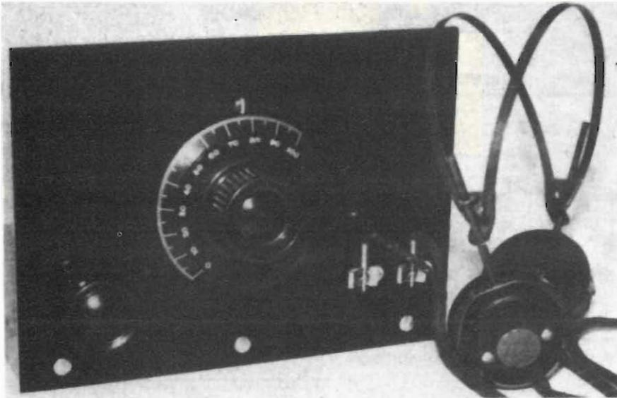
Fig. 8 - Pannello del ricevitore monotubo costruito con pezzi d'epoca.
