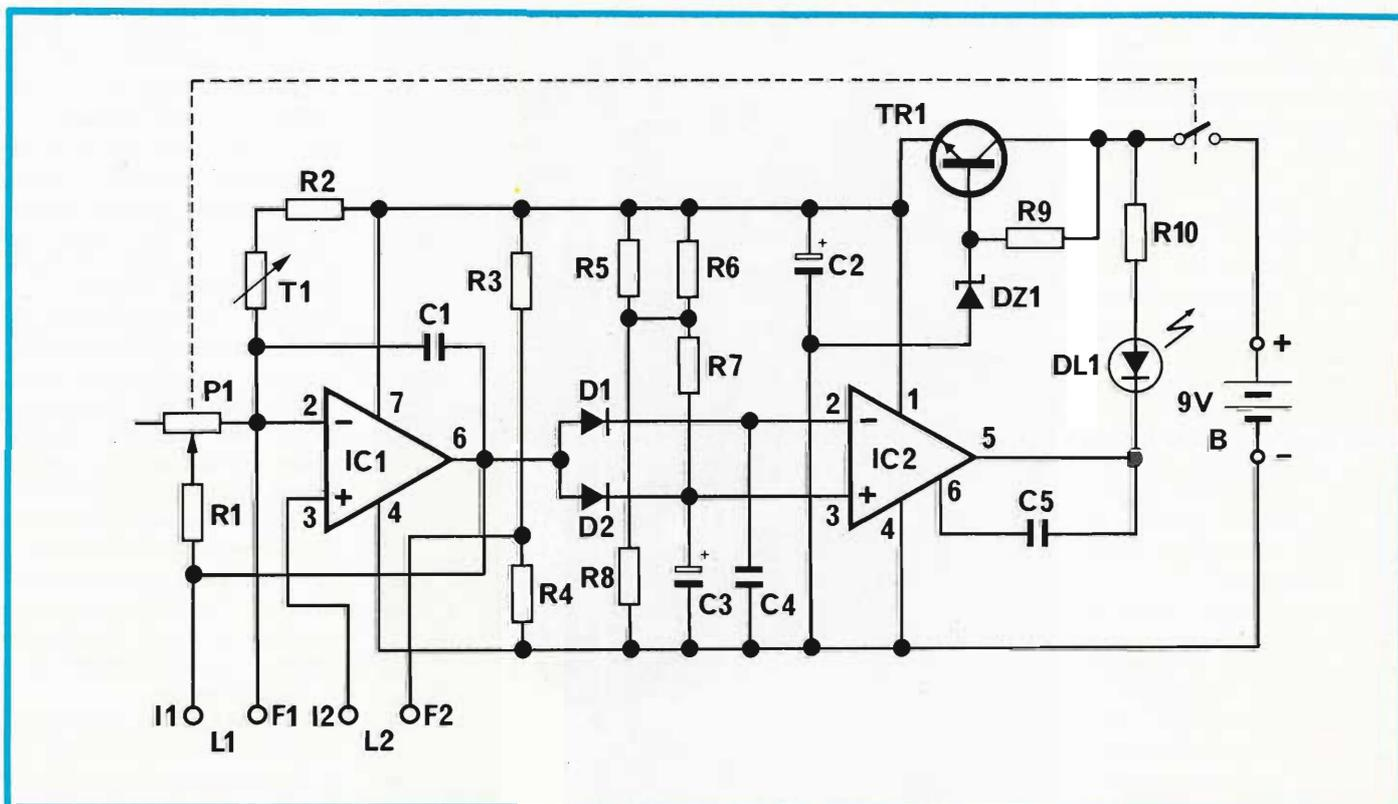
Fig. 1 - Circuito elettrico del cerca tubi tascabile.
